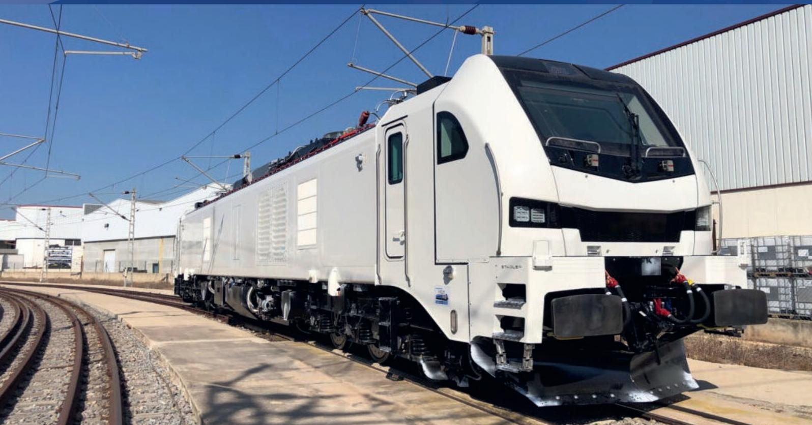
Die neue EuroDual sechsachsige Hybridlokomotive ist mehr als nur eine Lokomotive für die „letzte Meile“ und bietet zwei Lösungen in einer. Sie kann für den Schwerlastverkehr sowohl auf elektrifizierten als auch auf nicht elektrifizierten Strecken eingesetzt werden, und während des Betriebs ist es möglich, nahtlos vom Elektro in den Dieselmotor zu wechseln.
