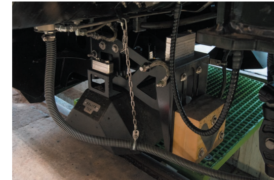
Die Antennen für das niederländische ATB (rechts), die italienische SCMT (links) und ...
