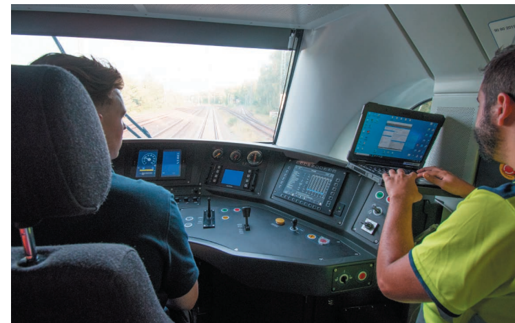
Während der Testfahrt werden die Daten der Euro9000 auch über die Service-schnittstelle per Laptop beobachtet.
