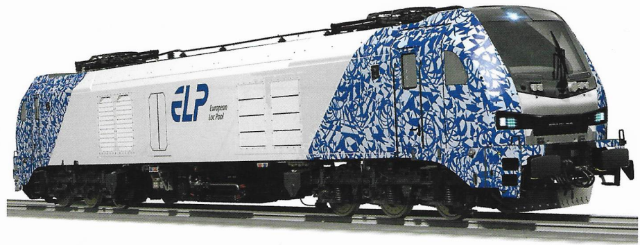
1: Euro9000 Dualmode Mehrsystemlokomotive mit 500kN Zugkraft und 9MW Leistung Quelle European Loc Pool AG.
