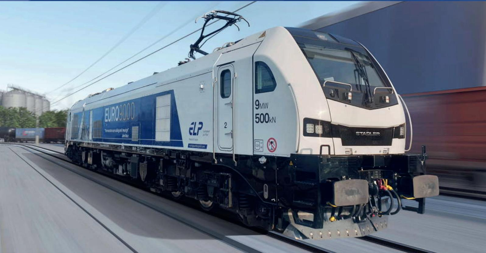
Die EURO9000 ist eine „Next Generation“ Hybrid-Mehrsystemlokomotive für den Einsatz in ganz Europa und vereint Effizienz mit Flexibilität. Die Lokomotive ermöglicht eine Zugkraft von bis zu 500 kN mit einer Leistung von 1,9 MW (2 x 950 kW) im Dieselbetrieb und bis zu 9 MW im elektrischen Betrieb. Die Euro9000-Plattform ist die natürliche Weiterentwicklung der erfolgreichen EuroDual- und Euro4000-Lokomotivfamilie von Stadler.
